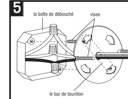
Attacher le bar de tourillon à boîte de débouché avec deux 8-32 vis (ne fournissait pas). Ces vis devraient être insérés par l'ouverture rectangulaire appropriée dans l'assiette et en le bar de tourillon. Serrer des vis.
