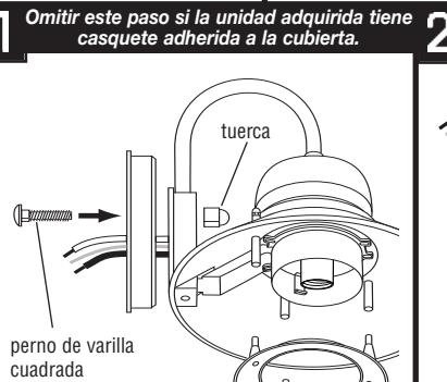
Pasar los cordones eléctricos de la cubierta a través del agujero grande en el casquete. Alinear las protuberancias en el casquete con las protuberancias en la cubierta e insertar casquete en la cubierta. Asegurarse que el casquete quede parejo a la cubierta. Insertar perno de varilla cuadrada en la abertura cuadrada detrás del casquete y asegurar con la tuerca.
