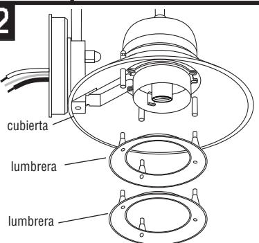
Alinear los postes encima de las lumbreras e insertar en los agujeros debajo de las otras lumbreras. Alinear los postes en la lumbrera de encima con las protuberancias de la cubierta y asegurar con los tornillos taladradores de 3 pulgadas.
