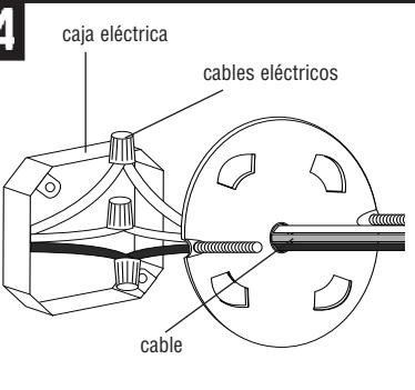
**CONNECTAR LOS CABLES.** NOTA: Unir cable negro del dispositivo al cable negro de la toma eléctrica, el cable blanco del dispositivo al cable blanco de la toma eléctrica. No los mezcle. Usar conectadores de cables eléctricos (no incluidos).
