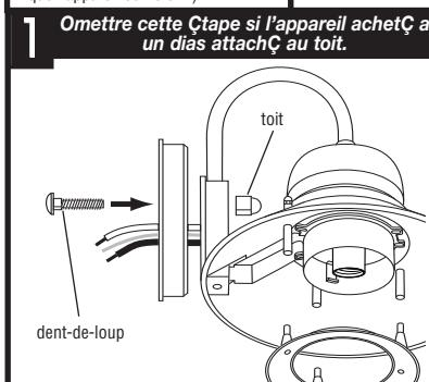
Introduire les fils du toit...travers le large trou rond du diaz. Aligner les deux renflements du diaz avec les renflements du toit et insérer le diaz dans le toit. S'assurer que le diaz est bien au même niveau que le toit. Insérer la dent-de-loup dans l'ouverture carrée au dos du diaz et fixer le toit au diaz avec l'écrou en forme de gland.
