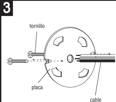
El hilo una pulgada cu largos tornillos en placa montadora y alimentan alambres de cierre a tráes del a gujero en el centro de la placa montadora.
