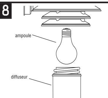
Installer l'ampoule dans la douille. S'assurer de Ne Pas Excéder la puissance en watts pour votre appareil d'éclairage. Visser le diffuseur dans le toit.
