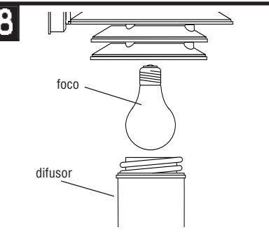
NOTA: El dispositivo tiene que calafatearse con calafateo (caulk) acrílico donde la base del dispositivo toca la superficie (el techo ó la pared) en que se montó. Ecalafateo crea un sellado impermeable en el lugar de instalación.
