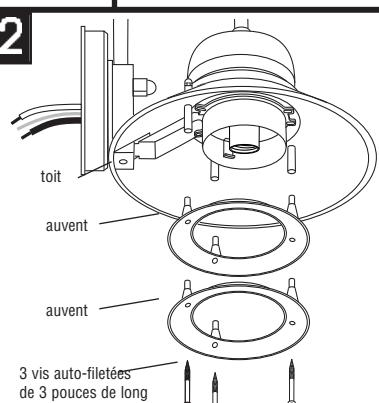
Aligner les bornes au-dessus d'un auvent et insérer dans les trous au-dessous de l'autre auvent. Aligner les bornes sur l'auvent du haut avec les renflements du toit et fixer la toit au diaz avec l'écrou en forme de gland.
