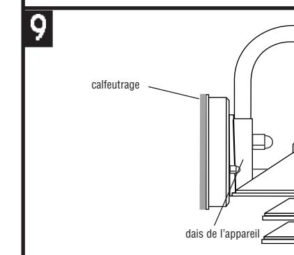
NOTE: L'appareil DOIT être caufeutré avec un caufeutrage acrylique là où l'appareil est en contact avec la surface de montage. ceci fournit un joint étanche lorsque l'appareil est installé.
