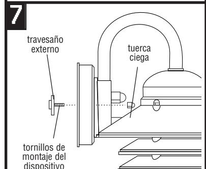
Colocar el dispositivo sobre los tornillos de de montaje del dispositivo y saquear en posición con las tuercas ciegas incluidas.
