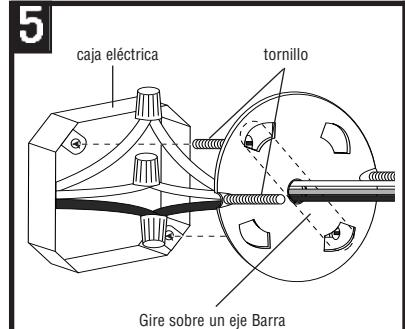
Incluya girar sobre un eje - prohíba a caja-de-enchuf e con dos 8-32" tornillos (no proveída). Inserten tornillos a través de apertura rectangular y en girar sobre un eje barra. Aprieten tornillos.
