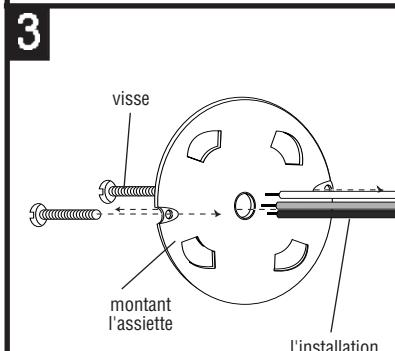
Le fil on avance des vis longs en monter des fils d'installation d'alimenter et assiette par le trou dans le centre de l'assiette l'assiente monter.
