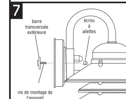
Placer l'appareil sur les vis de montage de l'appareil et s'assurer que l'ensemble est proprement fixé avec les écrou à ailettes fournis.
