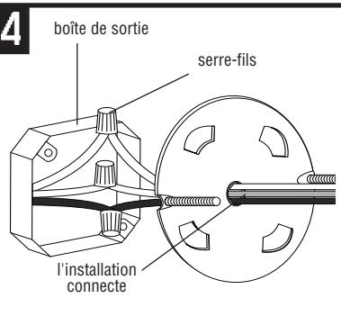
**RACCORDER LES FILS.** NOTE: attacher le fil noir de l'appareil au fil noir d'alimentation et le fil blanc de l'appareil au fil blanc d'alimentation. Ne pas les mélanger. Utiliser des serre-fils (non fournis).
