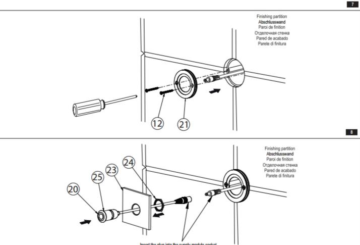
Insert the plug into the supply module socket. Stecken Sie den Stecker des Kabelbündels in die Steckdose am Versorgungsmodul. Brancher la prise måle dans la prise femelle du module d'alimentation. Воткните штепсель в гнездо на модуле подачи воды. Conectar el enchufe al nido en módulo de alimentación. Inserisci la spina alla presa nel modulo di alimentazione.
